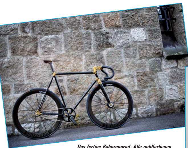
Das fertige Bahnrennrad. Alle goldfarbenen Teile wurden beim LAC lasergeschmolzen und bei einer externen Firma mit Titanitrid beschichtet. Foto und Fahrradentwickler: Ralf Holleis ( www.vorwaertz.com )
